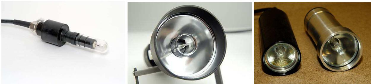
На мой взгляд, предпочтительнее классический вариант, так как в этом случае проще решаются проблемы герметизации (следовательно, возможна более лёгкая замена лампы и меньше вероятность протечки), возможен более широкий выбор рефлекторов (в случае пробирочной конструкции рефлектор находится в прямом контакте с водой, поэтому должен быть нержавеющей), кроме того, головка со стеклом имеет большую механическую прочность, надёжнее защищая оптическую систему фонаря от ударов.
