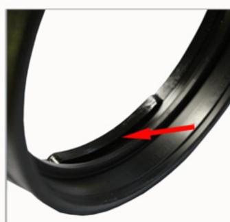
**Важно!** В процессе эксплуатации необходимо смазывать силиконовой смазкой кольца перчатки, а именно O-ринг и сопрягаемую с ним поверхность ответного кольца, а так же внутреннюю поверхность байонетных «зубьев» - показаны стрелками.
