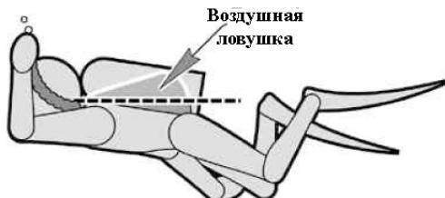
Рисунок ниже показывает преимущество крыла не подверженного обертыванию. Воздух в крыле теперь ниже уровня точки соединения инфлятора с крылом, позволяет дайверу свободно стравить воздух из крыла с помощью предохранительного клапана в локте инфлятора или через кнопки управления инфлятором. Крылья Travel, Trec и Rec, каждое имеет средство защиты от обертования вокруг одного баллона.
