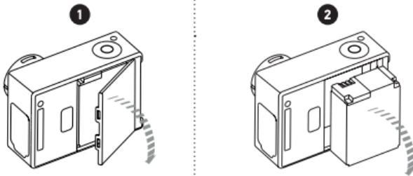
1. Снимите крышку аккумуляторного отсека, установив большой палец в углубление на крышке аккумуляторного отсека (на задней панели камеры), и отведите ее влево.
