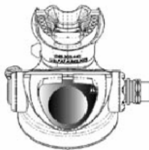
Затемненная часть показывает клапан выдоха и прилегающую область
