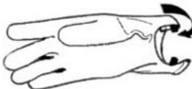
3. Проденьте перчатку с распорным кольцом внутрь соединительного кольца. Установите распорное кольцо в выемку соединительного. Для этого возьмитесь обеими руками за соединительное кольцо со стороны отверстия меньшего диаметра и кончиками пальцев проталкивайте распорное кольцо в выемку. При этом следите за равномерным натяжением перчатки и не допускайте образования складок, которые могут привести к разгерметизации.
