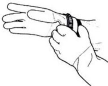
6. Для того, чтобы снять систему сухих перчаток, необходимо поворачивать разжимное кольцо по направлению от Cuff Ring или Quick Clamp. Для полного отсоединения сожмите руку в кулак и протолкните соединительное кольцо наружу.
