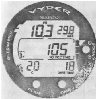
Рис. 3.12 Индикатор скорости всплытия. Четыре сегмента.
