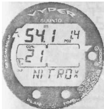
Рис. 3.20 Режим NITROX Максимальная глубина погружения при текущих параметрах смеси (21% O2 и 1.4 бар. PO2) - 54 м.
