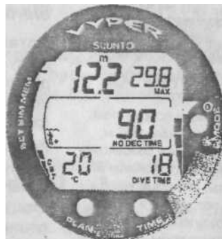
Рис. 3.11 Индикатор скорости всплытия. Три сегмента
