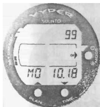
Рис. 4.37 Установка текущей даты.
