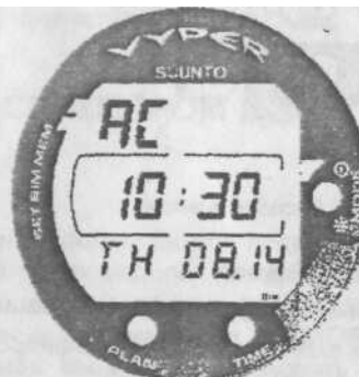
Рис. 2.4 Надпись AC появляется на дисплее при активации водоактивируемого контакта.
