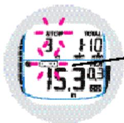
компьютер выводит на дисплей флаг DECO, подаются два звуковых сигнала по 3 секунды каждый.
