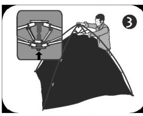
Давите на нижнюю часть крестовины вверх, до соединения обеих частей. Когда крестовины будут соединяться сопротивление будет усиливаться, и каркас палатки расправится.
