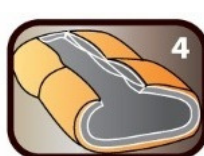
4 Утеплитель со смещёнными швами для исключения холодных зон
