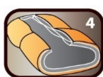
4 Утеплитель со смещёнными швами для исключения холодных зон
