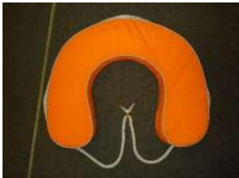
2.2. Круг-подкова выполнен из полиэтиленового наполнителя с закрытой ячеистой структурой и обшит тканью. В качестве оболочки – синтетическая ткань с пределом прочности по основе не менее 755 Н/5 см, по утку – не менее 589 Н/5 см.
